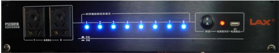
PSC801B 時序器能夠按照系統由前級到後級的順序逐個啟動各類設備：關機時則由後級到前級的順序關閉系統設備。這樣就能有效的統一控制所連接的用電設備，避免了人為的失誤操作，徹底解決了終端器材(如功放.喇叭等)可能由於這種失誤造成的損害,同時又可減低開/關用電設備對輸電線路的衝擊電流，由於其性能優越,將使系統管理員永遠告別繁瑣開機的操作。用于控制系統用電設備啟/切斷的時序器,是音響工程,電視廣播系統，電腦廣播系統，電腦網路系統及其它電氣工程必不可少的元素。
